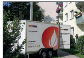
Mobile fahrbare Heizzentralen
